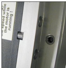
Zum Lieferumfang gehören eine Montageplatte, eine Adapterplatte, 2 Passfedern 10 mm und 8 Innensechskantschrauben. Die Montageplatte wird mit der Passfeder auf die Maschine aufgesetzt und mit den vier kurzen Schrauben befestigt.
