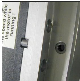
L'outil est fourni avec un support de montage, une clé de 10mm et 4 vis Allen M8x20. Le support de montage est placé sur la carotteuse avec la clé et fixé au moyen des 4 vis.
